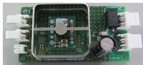
(ノイズ抑制体内蔵基板にリフローで部品実装)
